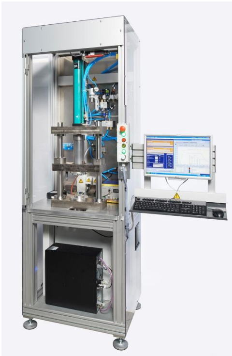
Gesamtansicht µHammering Prototyp
