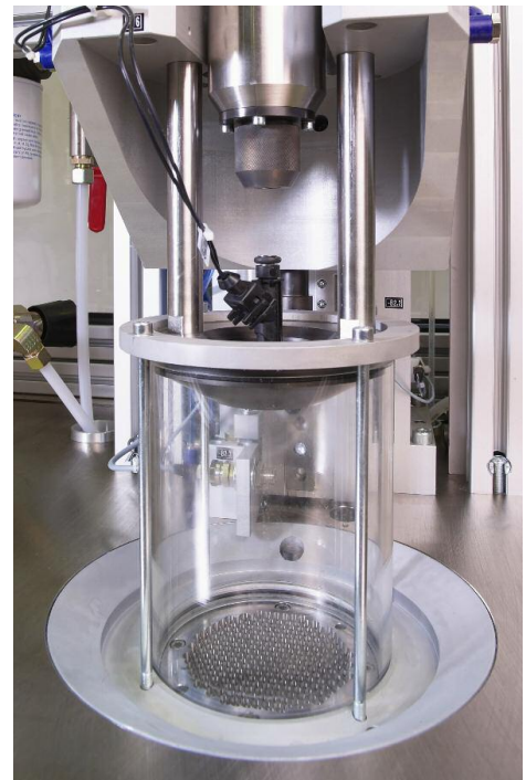
Messzelle, Injektoraufnahme mit Prüfling
