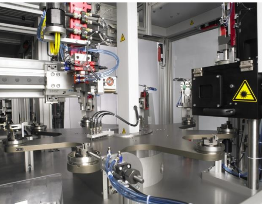
Rundtisch mit Teststationen
