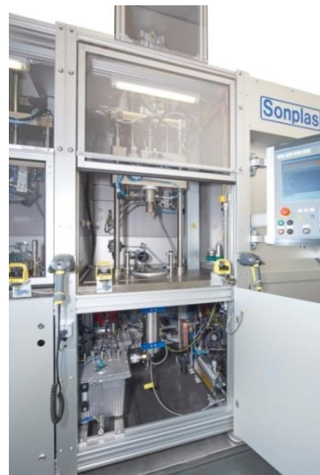
Durchflussprüfstation mit automatisierter Injektor-Kontaktierung
