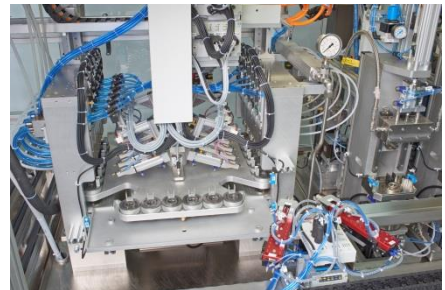
Rundtisch mit Spül- (rechts) und Ausblasstationen (links)
