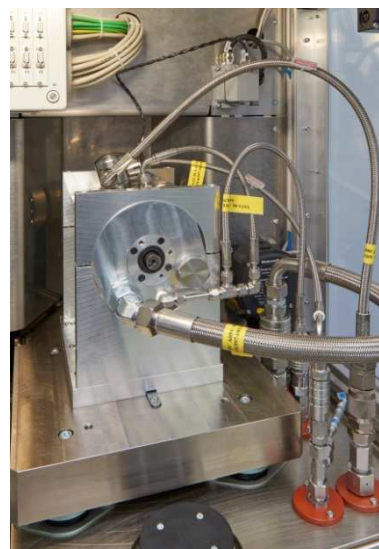
Prüfling mit Nockenwellenbox
