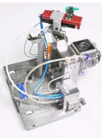
Typspezifischer Werkstückträger inklusive CAM-Box
