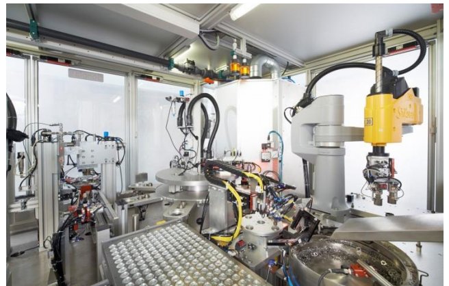
Beladeschublade, Rütteltopf und Komponenten-Beladeroboter
