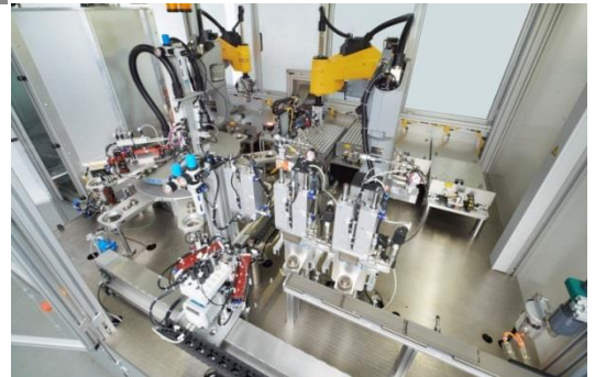
Be- und Entladeroboter, Schweißkammer, Stroke-/ Leckagetest
