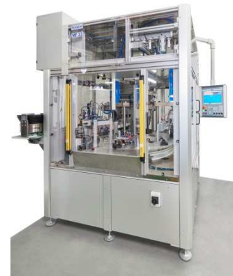
Rundtischstation zur Montage und Einstellung von Überdruckventilen
