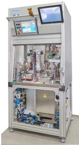
Doppelstation zum Schweißen und Prüfen
