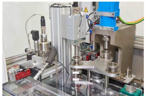
Rundtisch mit Einpress- und Luftdichtheitsstation
