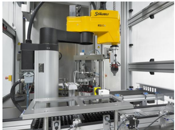
Paletten-Handling und Roboter-Beladung der Stationen
