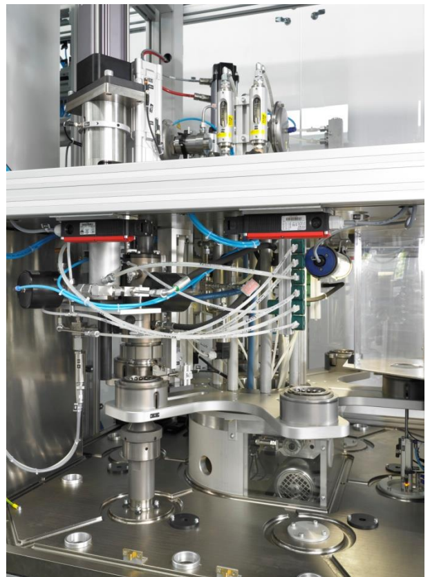
Öffnungsdruckstation mit servomotorisch gesteuerter Pumpe
