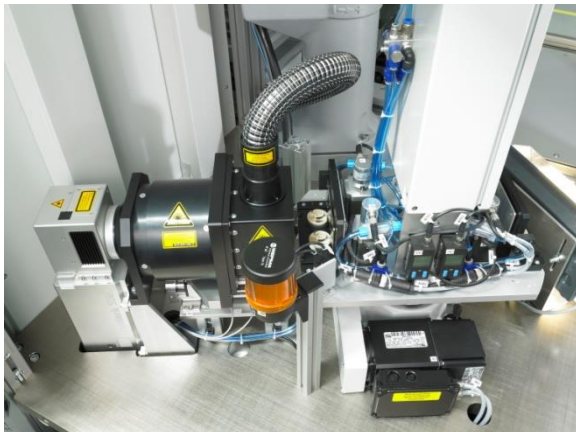
Laserkammer mit Rundtisch
