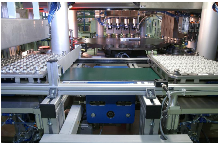
Rundtisch hinten: Einlaufstation, Rundtisch rechts: Messstation
