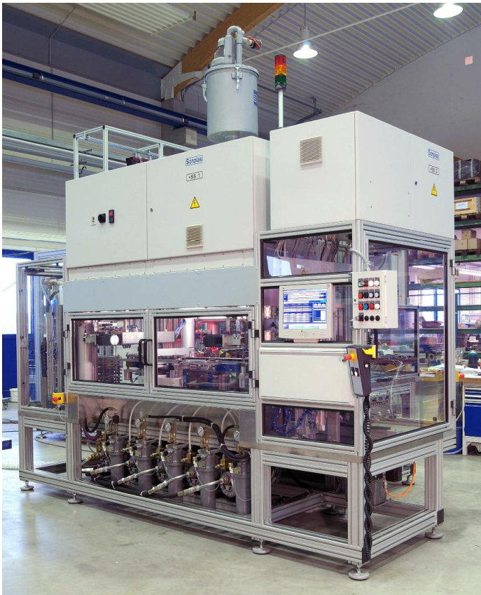
Vorderansicht: links Beladeseite, rechts Entladeseite mit Bedienpult und Monitor
