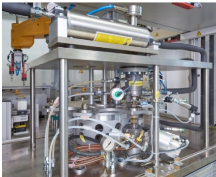
Ausblas- und Prüfstation mit Rundtisch
