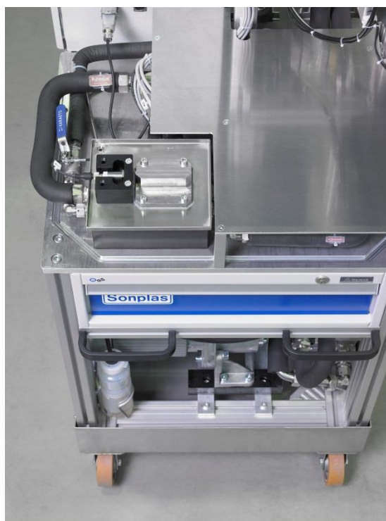
Detail der Prüflingsaufnahme für Volumenstromsensoren
