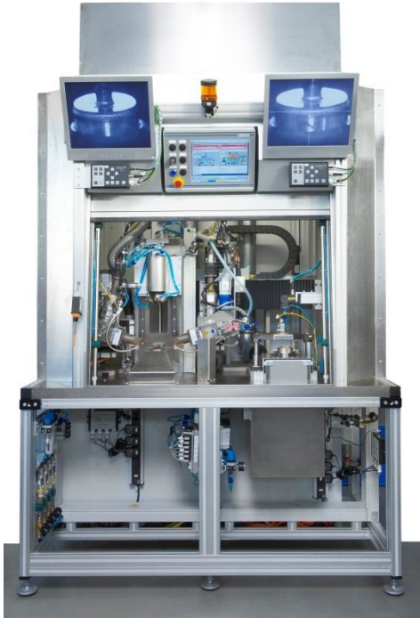
Doppelstation für Schweißung mit Doppelfokus
