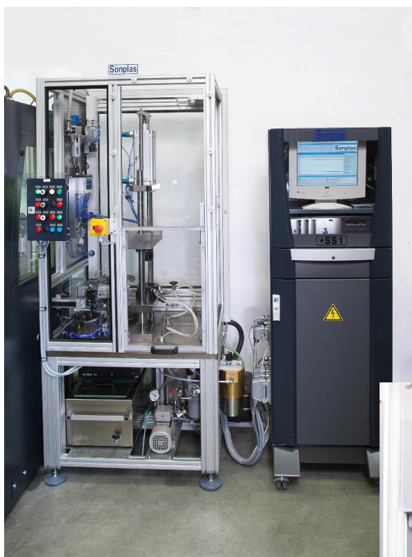
Backleak-Tester mit Schaltschrank (links Zuführgerät zur automatischen Bestückung)
