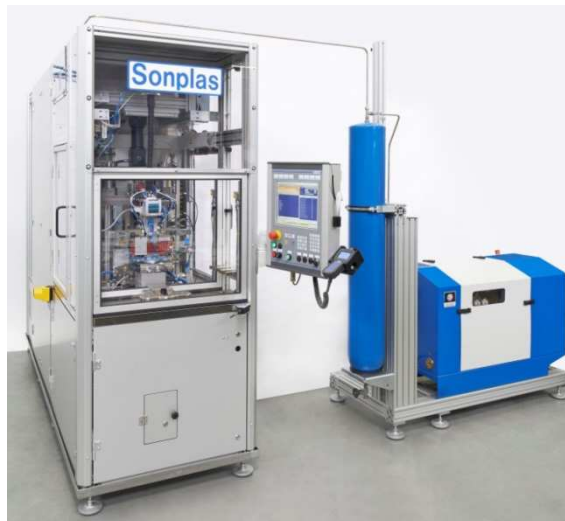
Gesamtansicht Einzelprüfstand mit Stickstoff-Hochdruckerzeuger
