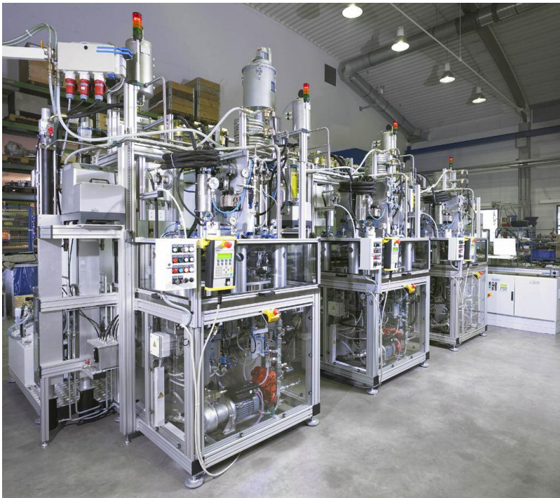
Anlage mit 3 Rundtischautomaten
