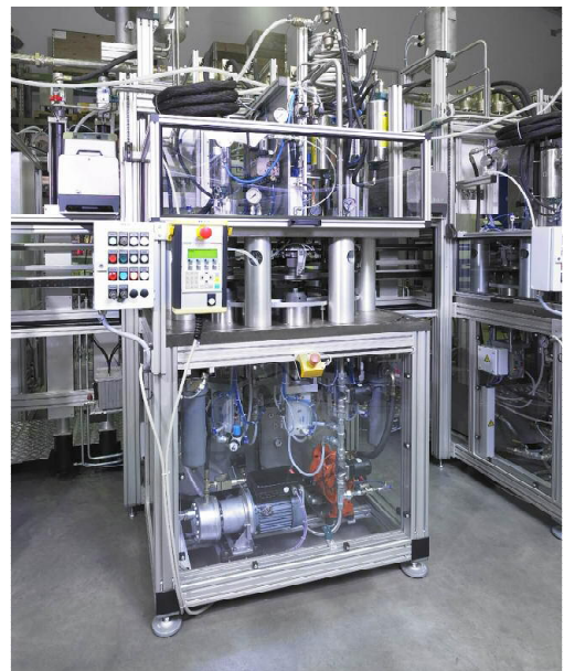
Rundtisch mit Hand-Held-Bedienpanel
