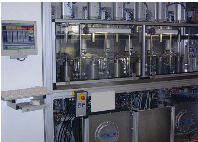
Vorrichtungsraum mit 4 Schleifstationen und 2 Spülstationen
