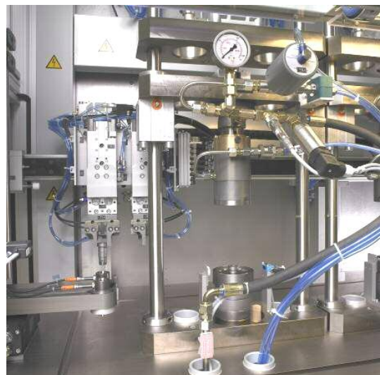
Werkstückhandling mit Doppelgreifer und Drehvorrichtung
