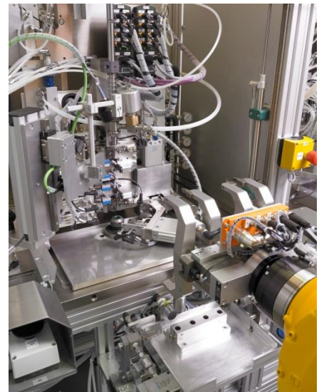
Vorrichtung mit Roboter in Beladestation
