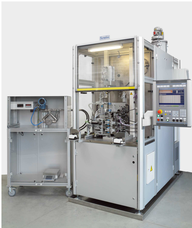
Durchflussprüfstand mit Kalibrierzubehör (links im Bild)
