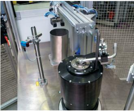
Rohrschneidstation mit Abfallhandling
