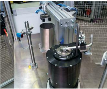
Rohrschneidstation mit Abfallhandling
