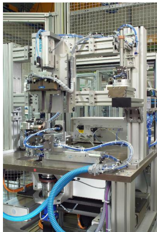
Balgbiegestation mit Dichtheitsprüfung
