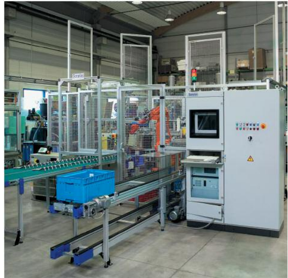
Roboterzelle mit Ein- und Auslaufbänder
