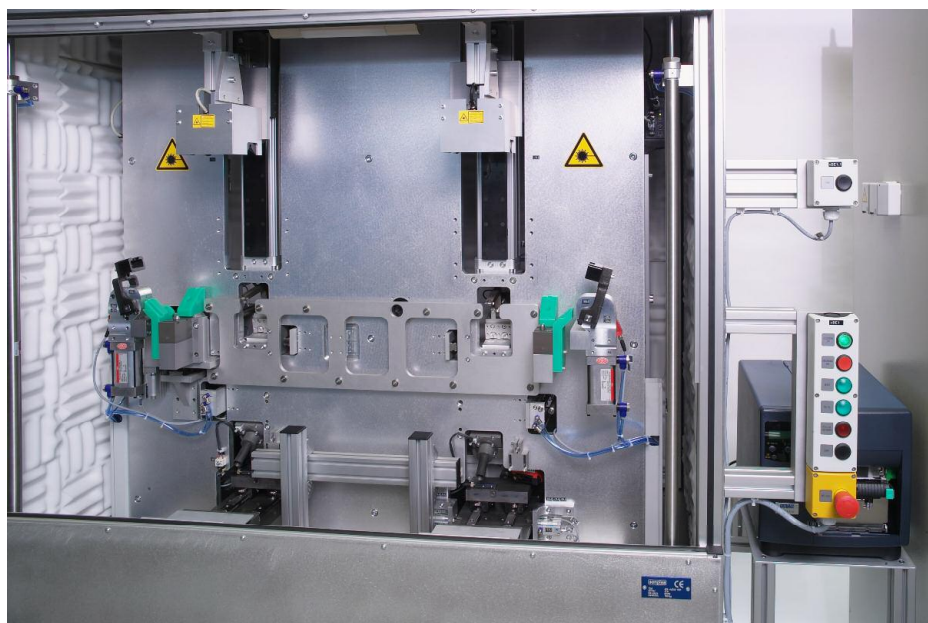
Prüfvorrichtung für Doppelüberrollbügel
