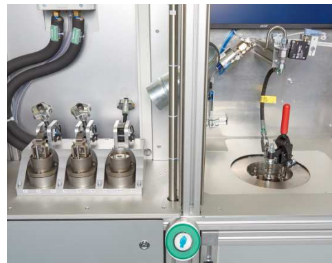
Spül- und Strahlprüfstation
