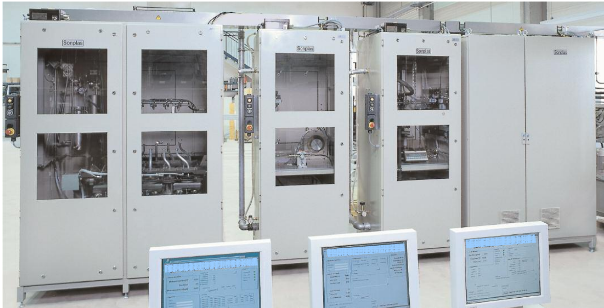
Gesamtansicht von Einzelinjektor-, Pumpen- und Railprüfstand, sowie des Hydraulikschrankes mit der Kraftstoffversorgung
