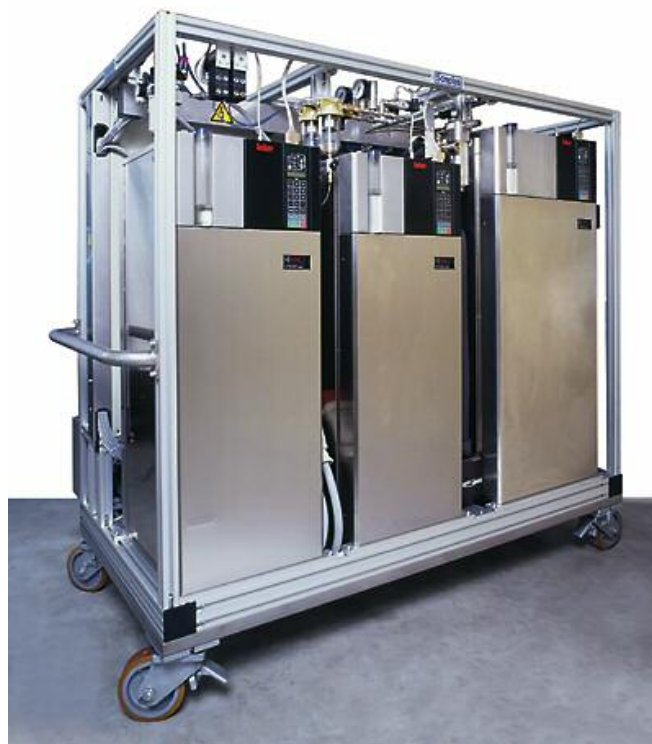
Konditionierwagen mit Kryostaten
