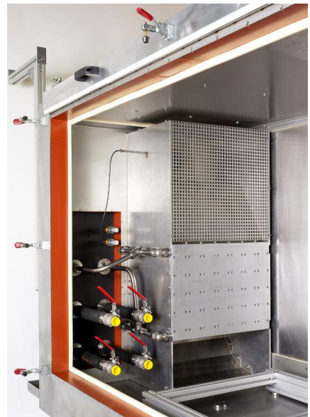
Innenraum Klimakammer mit Hochleistungswärmetauscher
