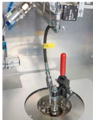
Spül- und Strahlprüfstation
