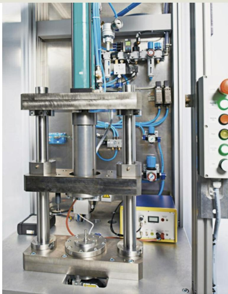
**Bild 1.** Die Microhammering-Station zur Einstellung und Positionierung im Mikrometerbereich, beispielsweise hier zur Hubeinstellung eines Benzin-Hochdruckinjektors
