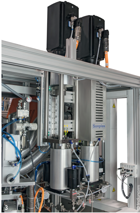
1 Um die Einstelllinien von Benzin-Einspritzventilen zu automatisieren, setzt Sonplas THK-Bogenführungen ein.
